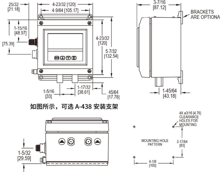
ISDP 系列本安防爆型微差压变送器采用 NEMA 4X 的防护，输出 4-20mA 信号，大屏的 LCD 显示，可编程显示差压，流速或流量。可通过面板的按键来编程设置：安全级别，英制公制的工程单位，风速或风量，皮托管 K 系数，圆管，矩形管尺寸用于计算流量，等等。ISDP 采用两线制，10-35V 电源，带 4 针 M-12 连接头。它的精度为 0.5%，量程范围从 0.25 - 100 英寸水柱，还有正反双向量程到 10 英寸水柱。这些使得 ISDP 变送器非常适用于危险场合来监测差压或风速风量，防爆级别为 Class I Div. I Groups A, B, C, D; Class II Div. I Groups E, F, G; Class III Div. I。
